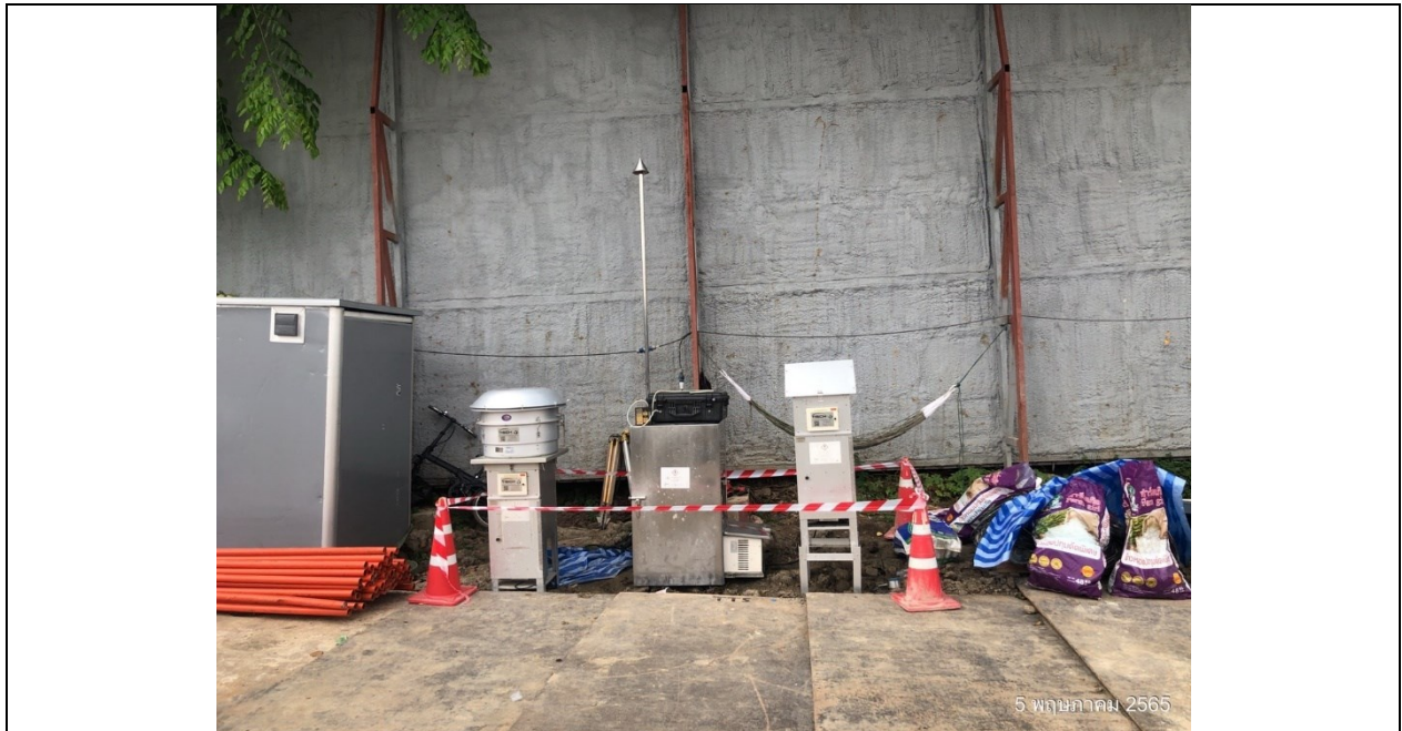
รูปที่ 3.2-2 การเก็บตัวอย่างคุณภาพอากาศในบรรยากาศ บริเวณพื้นที่โครงการ
