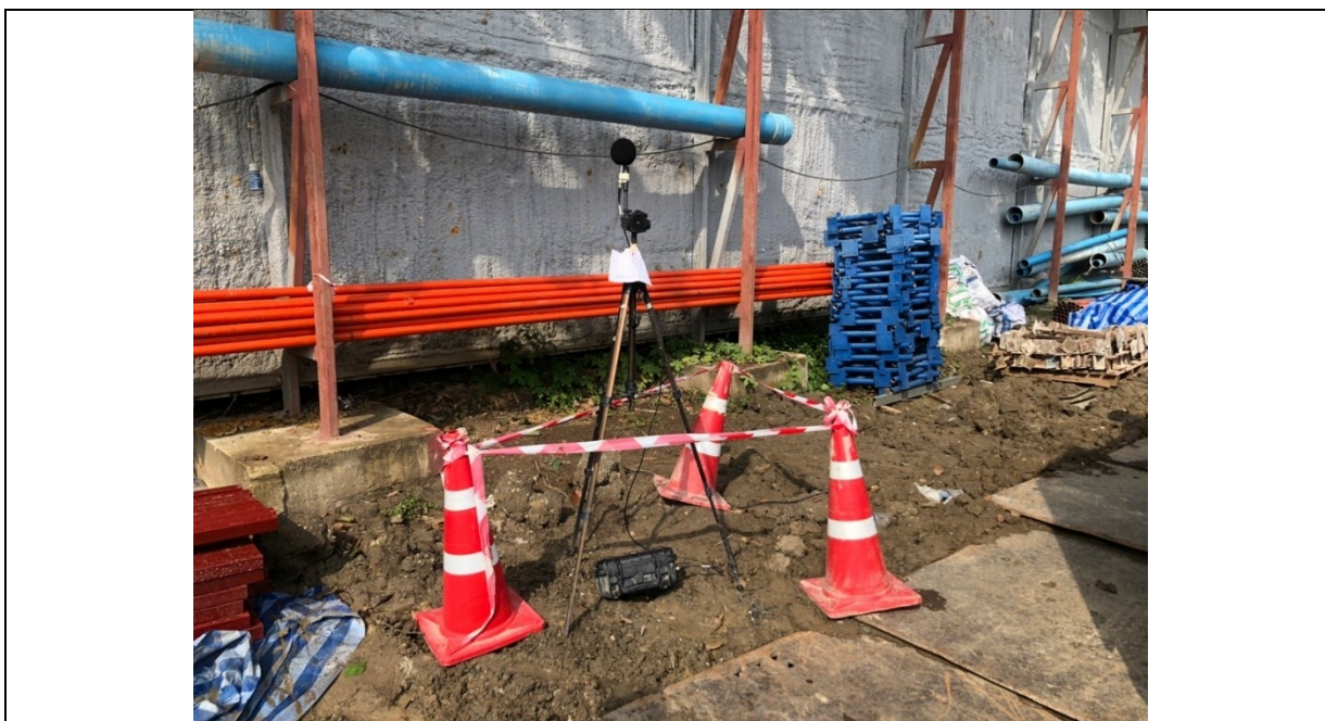
รูปที่ 3.3-2 การเก็บตัวอย่างระดับเสียงและความสั่นสะเทือนบริเวณพื้นที่โครงการ
